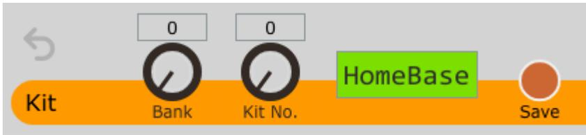
Außerdem gibt es eine Undo-Schaltfläche (oben links), die aktiv wird, sobald eine Instrumenten-Variation des gewählten Kits geändert wird. Die Undo-Funktion setzt das gewählte Kit wieder auf den ursprünglichen Stand zurück.
